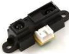
*Ilustración 14: Sharp GP2Y0A41SK0F
