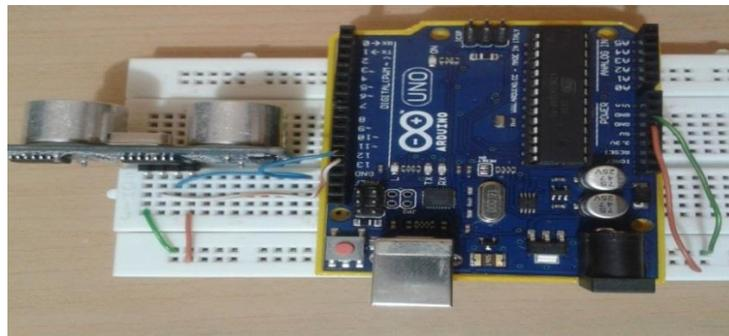
Ilustración 6: Conexión pruebas de funcionamiento sensor Ultrasonido
