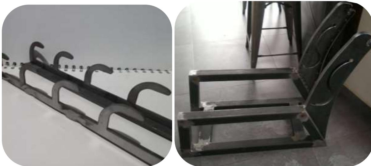
*Nota:* El proceso de soldado se realiza en Metal Cortes S.A.S, previo al proceso de soldadura se realizan unas partes en corte laser para metal.
