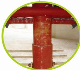
*Parte interna superior, donde muestra la forma de adherir sus partes (taches)*
