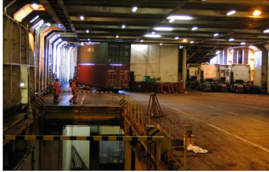
**Ilustración 10. Interior buque Ro (Roll on - Roll of)**
