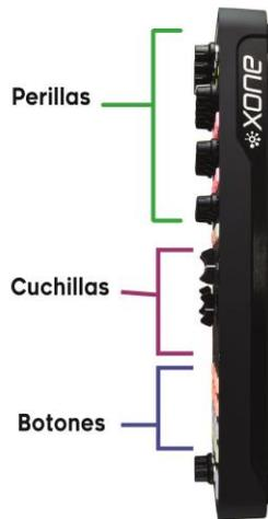
**Ilustración 5:** Ubicación de componentes de los equipos susceptibles a daños (vista lateral).
