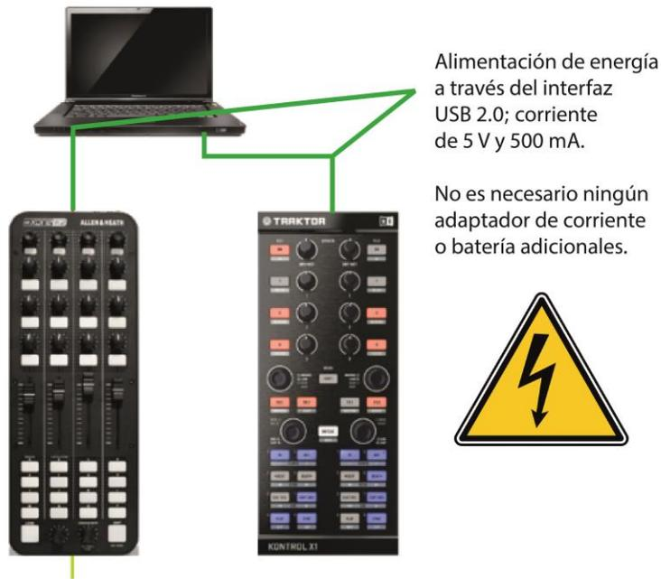
**Ilustración 26:** Explicación de alimentación de energía de equipos a transportar.
