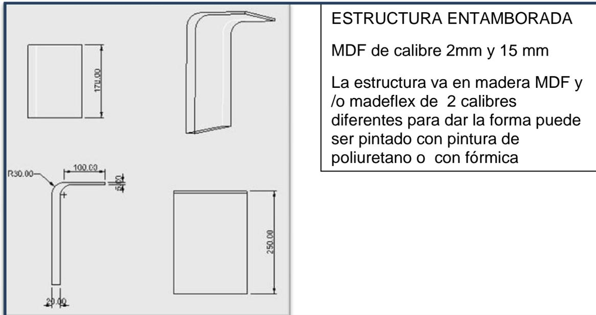
Ilustración 96 plano técnico propuesta 1 ceiling wall
