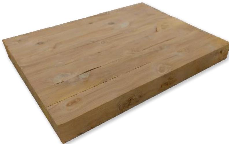
*Figura 31 Ensamble con adhesivo*
