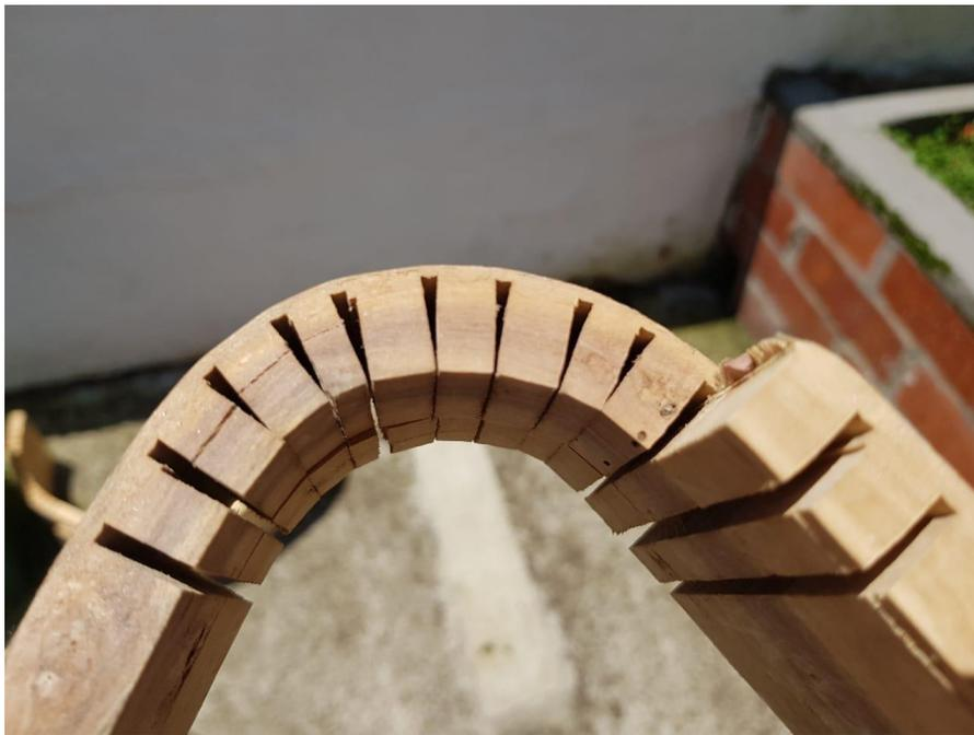
*Figura 51: Curvatura de madera*
