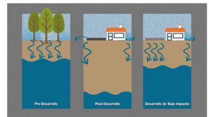
Imagen 8: Ciclo natural de las aguas lluvias con la utilización de pavimentos permeables.
