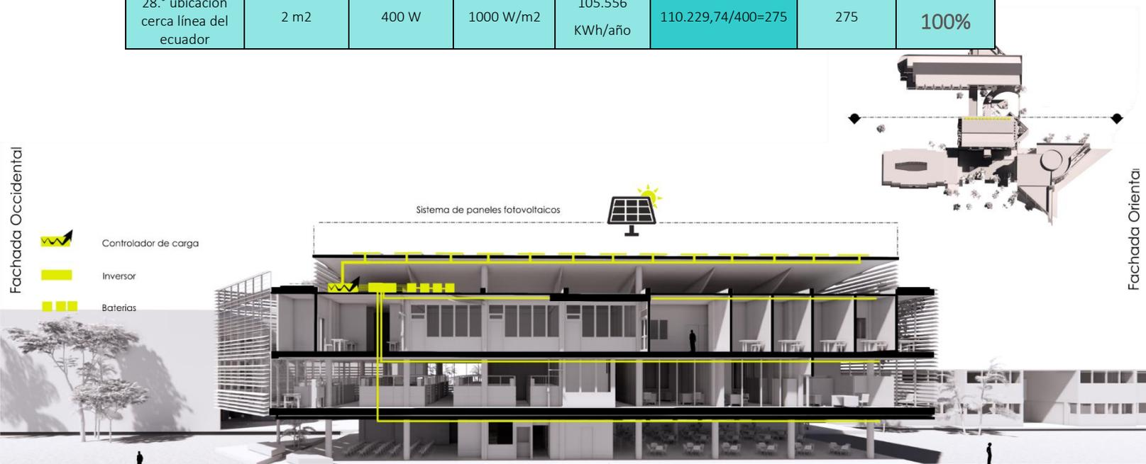
La instalación On-Grid funciona conectada a la red eléctrica y no utiliza tantos elementos en su sistema de funcionamiento. Se usa la energía de los paneles solares y las cargas extras se envían a la red para ser utilizada en su momento. Este sistema es más eficiente y tiene menor costo (CELSIA,s.f.).
