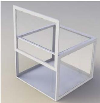
Inicialmente, el cubo de exhibición se diseñó con una puerta lateral deslizante para facilitar el montaje y desmontaje de las piezas de joyería, después evolucionó a una caja completamente desarmable, para optimizar su almacenamiento y transporte.
