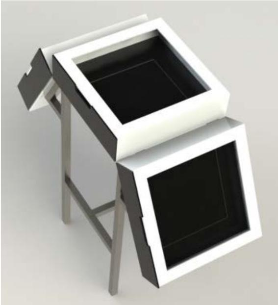
La alternativa 1 es una evolución de la primera propuesta. Consiste en una caja rectangular en MDF abierta en la parte superior protegida por vidrio templado de 3mm o policarbonato transparente de igual espesor. Esta caja tiene una bandeja deslizable que entra por uno de sus costados, la cual sirve para posicionar las diferentes piezas de joyería para la exhibición.
