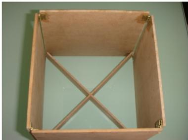
Posteriormente se realizó un modelo a escala 1:2 en MDF de 3mm para verificar la viabilidad de las bisagras y para comprobar el buen funcionamiento de la estructura interna.
