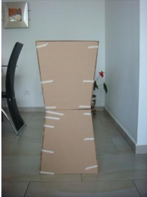
Se realizó un modelo tridimensional en cartón corrugado para verificar las dimensiones a escala real.
