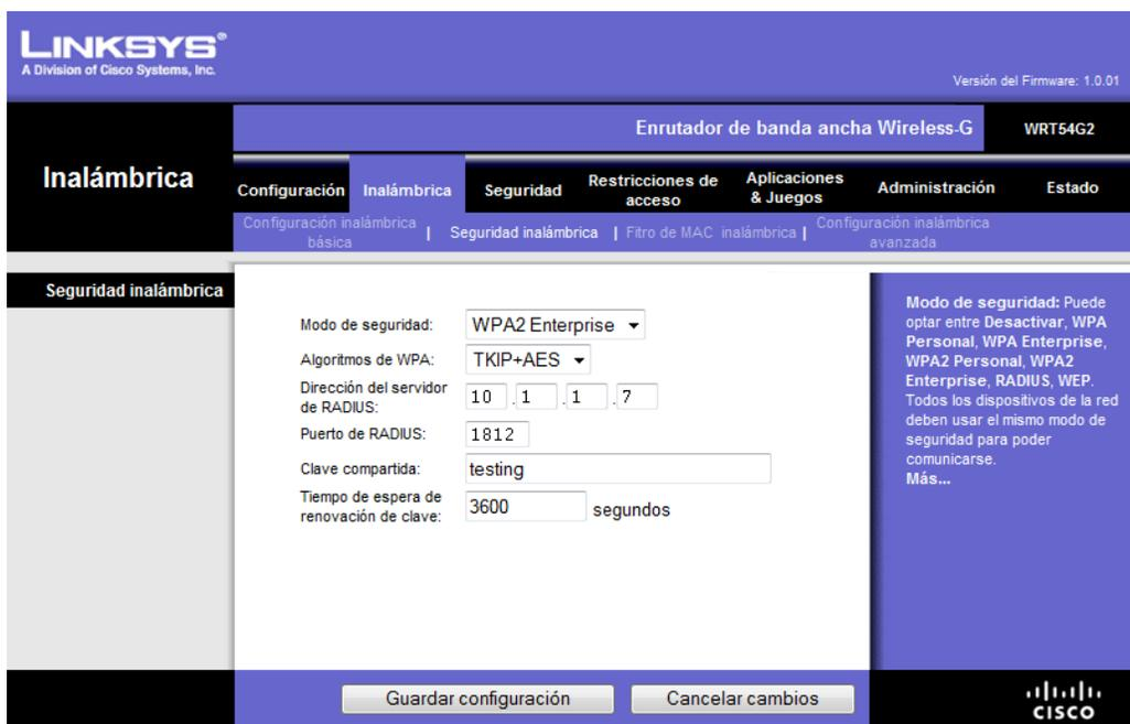
Figura 32 Gráfica (Configuración AP/Inalámbrica/Seguridad Inalámbrica)
