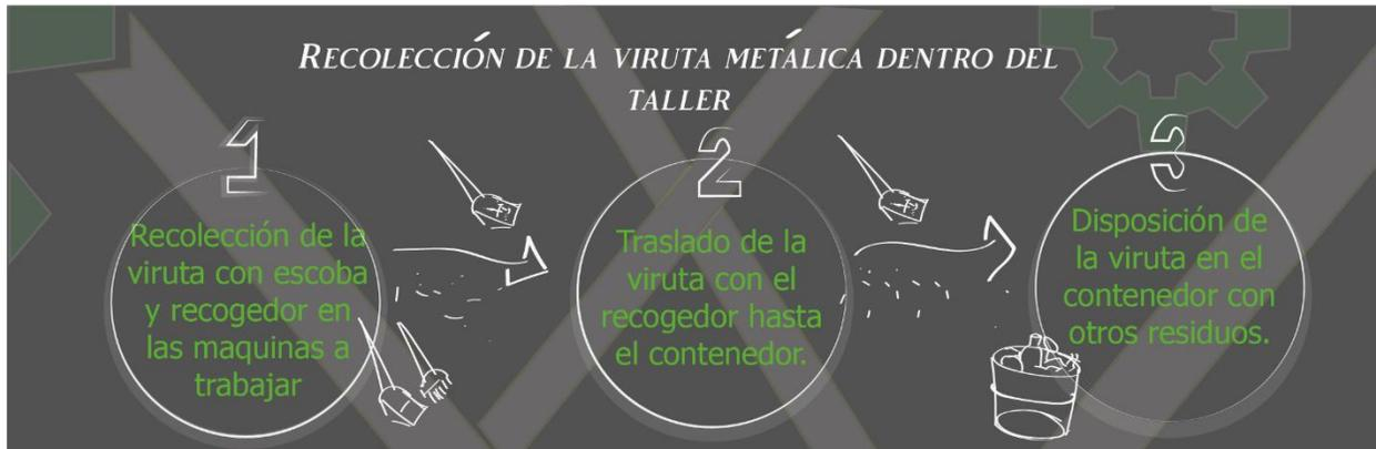
**Figura 10.** Recolección de la viruta metálica en el taller **Fuente.** Elaboración propia.
