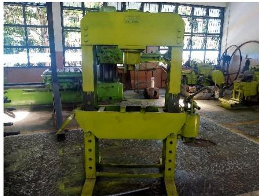
**Figura 12.**La Prensa Hidráulica de la Institución **Fuente**. Elaboración Propia
