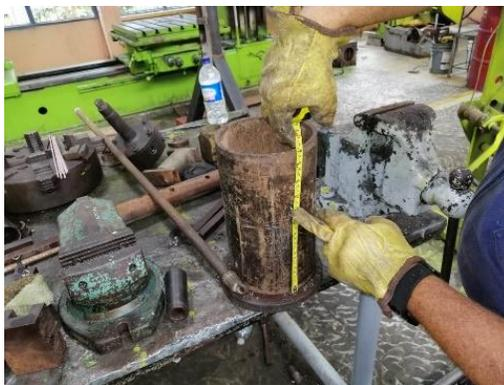
**Figura 13.** Cilindro y base utilizados en el ensayo de compresión de la viruta **Fuente.** Elaboración Propia.
