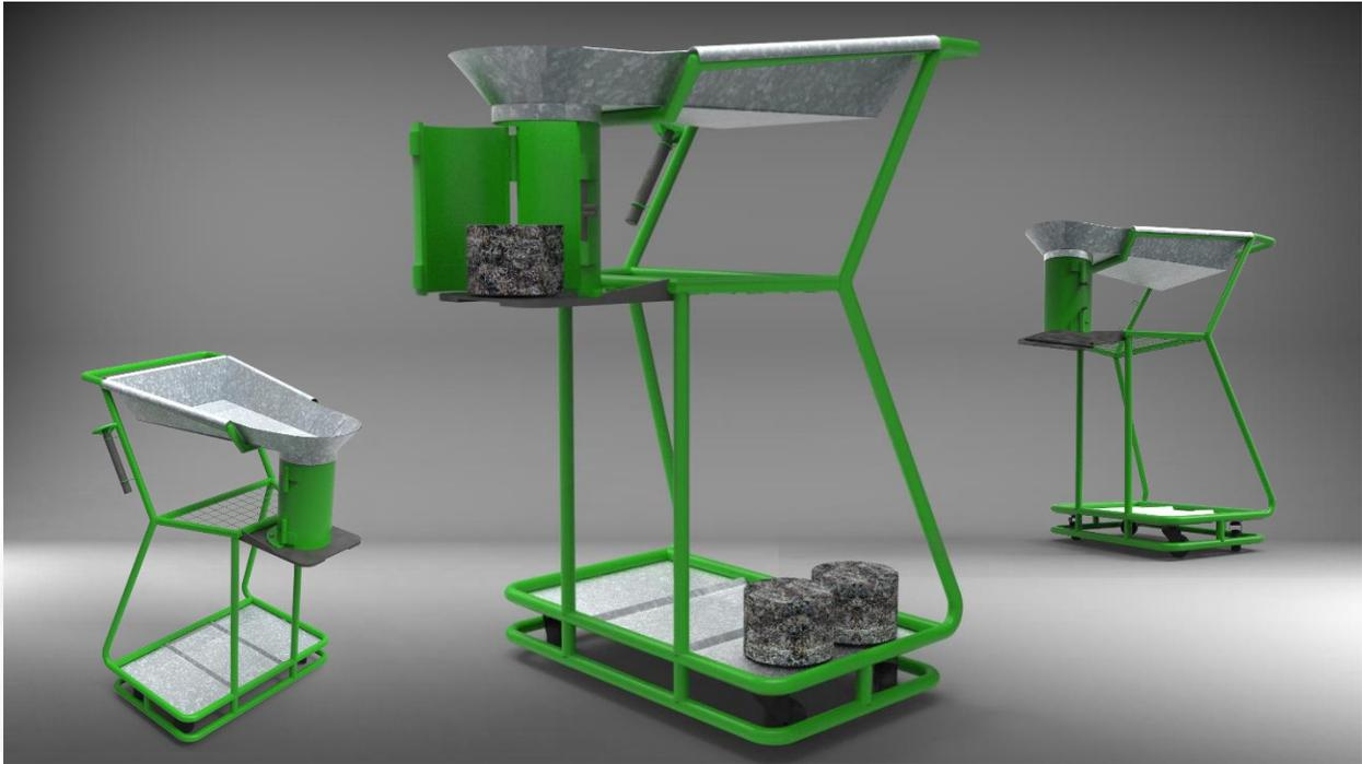
**Figura 45.** Render final - Sistema de recolección, transporte y compresión **Fuente.** Elaboración Propia
