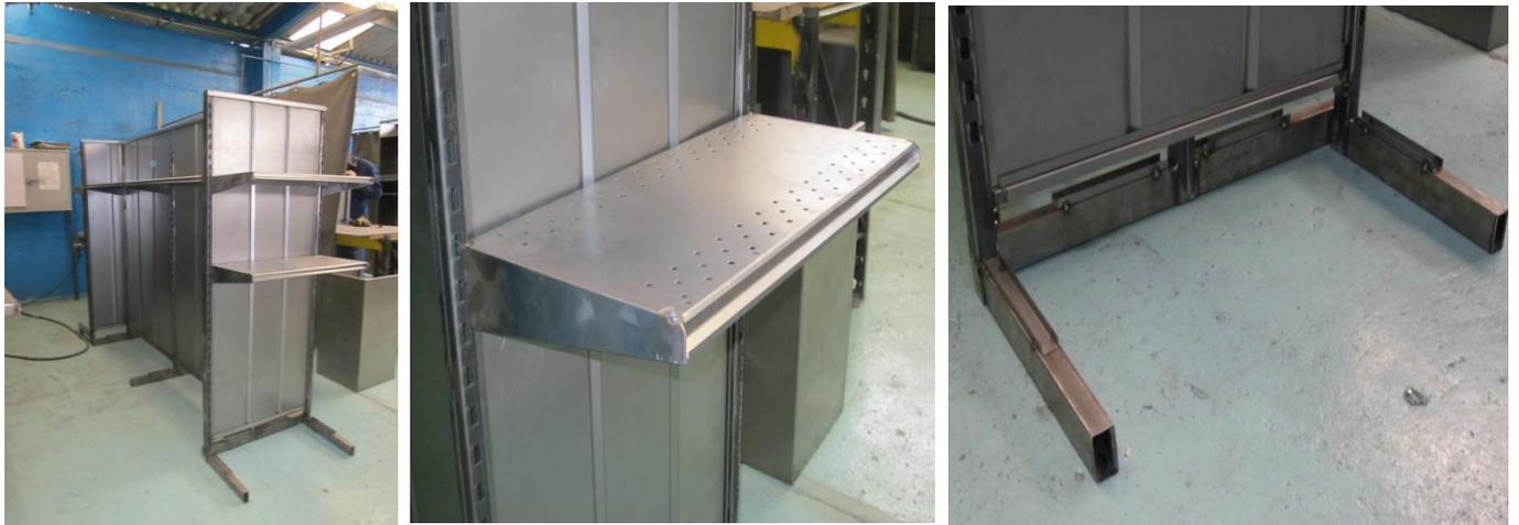
**Ilustración 62: Proceso de producción góndola**
