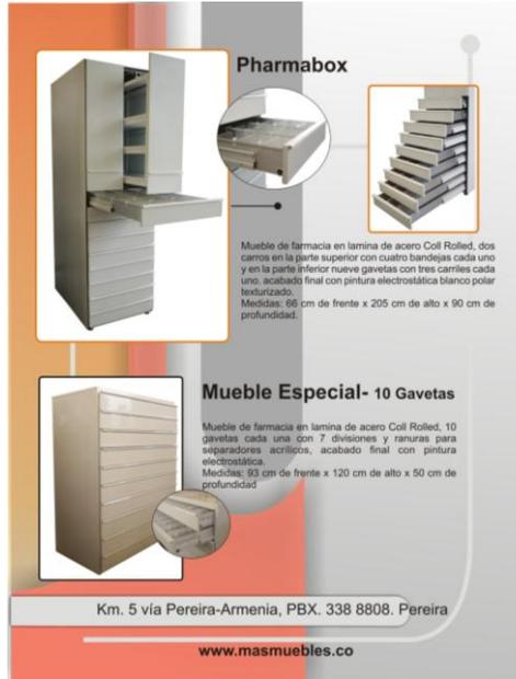
Mueble de farmacia en lámina de acero Coll Rolled, dos carros en la parte superior con cuatro bandejas cada uno y en la parte inferior nueve gavetas con tres camles cada uno, acabado final con pintura electrostática blanco polar texturizado.
