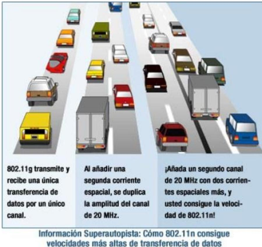
Figura 10. Comparación de transferencia de datos
