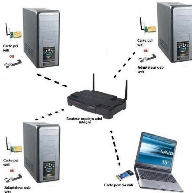
Figura 3. Modelo de una red WI-FI.
