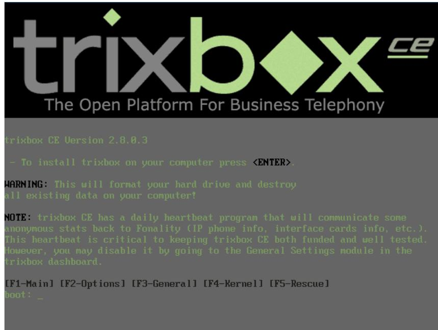
Figura 1. Instalación Trixbox CE.
