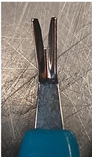
Figura 14. Forma principal de la cuchilla de corte. Fuente: elaboración propia
