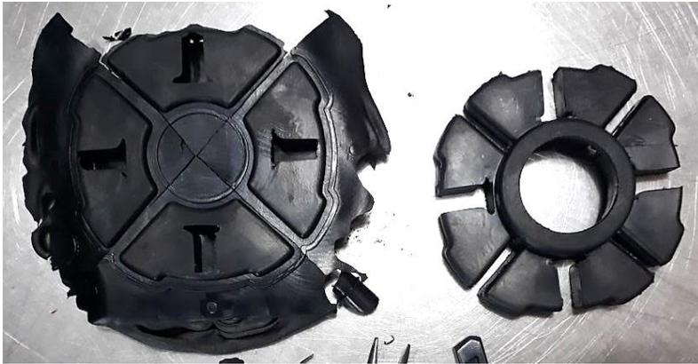
Figura 4. Antes y después de pieza antivibrante campana A-116. Fuente: Elaboración propia
