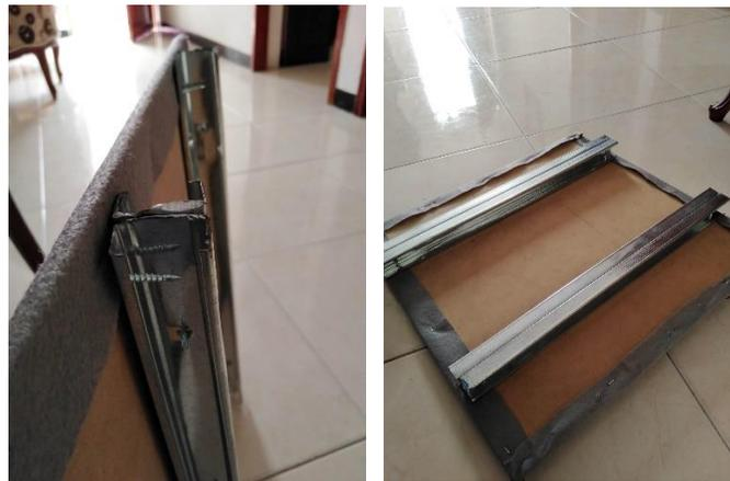
Figura 47. Simulador estructura portante en madera y perfiles de aluminio
