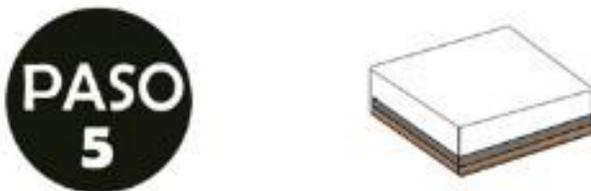
Basea un poco de la mezcla de concreto hasta completar 0.07 M de espesor en cada hoyo
