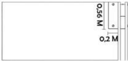
Antes de instalar los paneles debemos hacerles un corte de 0,56 x 0,2 M en las esquinas superiores para que encajen con el ensamblaje de la columna - viga
