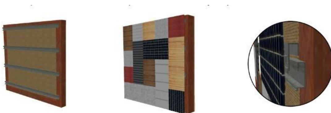
*Ilustración 34 Fachada flotante de materiales reciclados (fuente: Alejandra Durán)*
