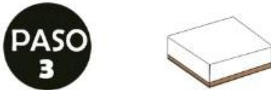
Adiciónale una capa de 5 cm de solado (concreto de baja resistencia)
