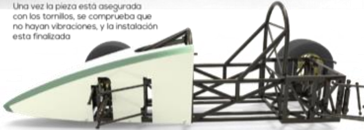
Figura 4. Secuencia de armado de la autoparte sobre el chasis. Fuente: Elaboración propia.
