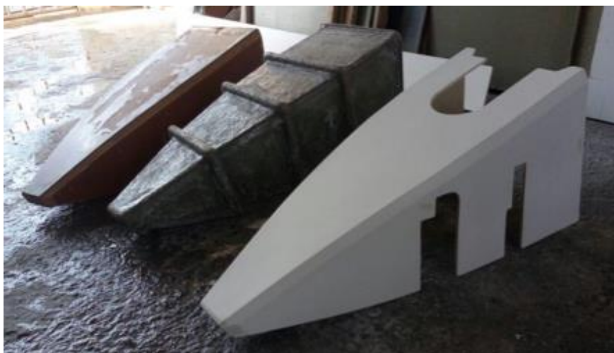
Figura 6. De izquierda a derecha, matriz de madera, molde fibra y pieza final
