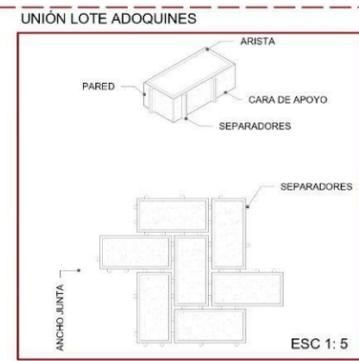
Ilustración 68. Unión de adoquines.
