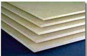
Tablero de fibra de densidad media. Se caracteriza por su composición homogénea a través de todo su espesor. Viene en densidad de 850 Kg. Por m<sup>3</sup> en los delgados y en 600 Kg. Por m<sup>3</sup> los gruesos. Se emplea para los muebles aereos y las partes que directamente no estan en contacto con la humedad.
