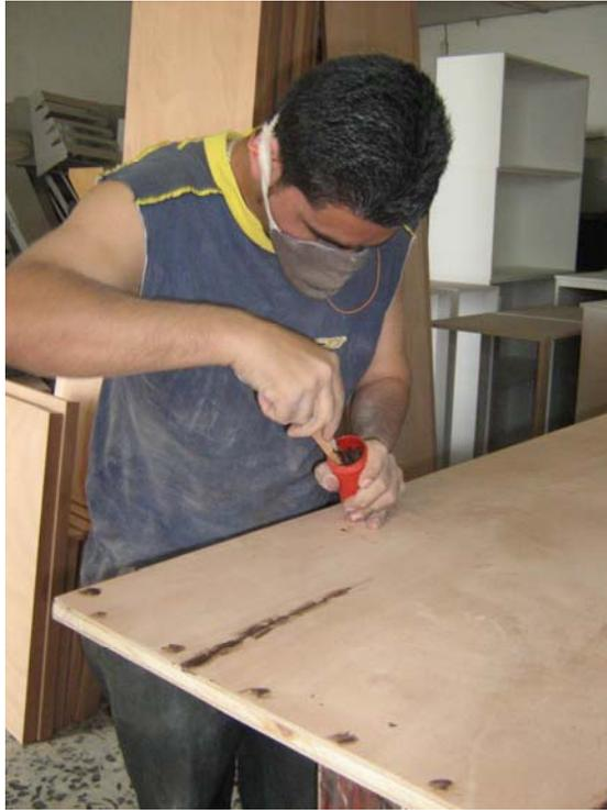
Foto 9: Ensamble: las piezas se ensamblan antes de lijar o pintar para asegurar que la tarea esta hecha bajo las medidas requeridas, así se corrobora y se corrigen errores i es el caso.
