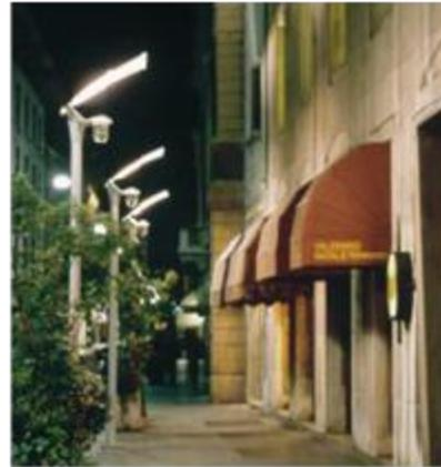
UN GLOBO DE VIDRIO RECIBE EL BLOQUE ÓPTICO QUE DEJA FILTRAR FINOS RAYOS DE LUZ. EPSILON, SUJETADA A UNA ALTURA DE MAS DE 4 METROS. ESTA DISEÑADA PARA LÁMPARAS DE HALOGENUROS METÁLICOS CON QUEMADOR CERÁMICO DE HASTA 150 W
