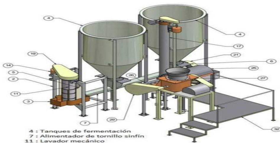
Figura 2. Concepto de la tecnología ECOMILL®: tanques de fermentación cilíndricos, alimentador de tornillo sinfín y lavador mecánico (patente en trámite).
