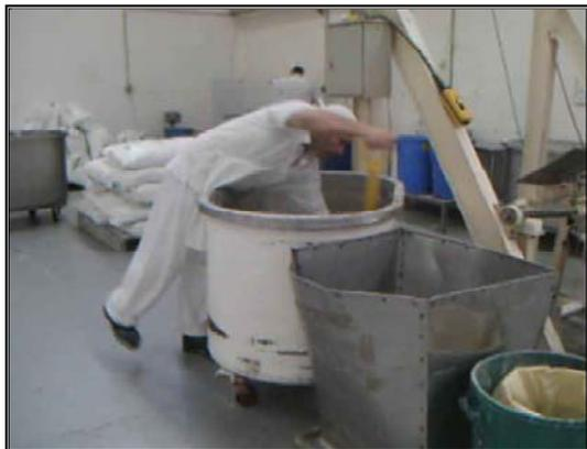
**El operario saca la masa para expulsarla por el ducto que llega a la maquina de laminación , la herramienta es una pala que les permite seccionar la masa, separarla y con las manos agarran la masa y la depositan en el ducto**
