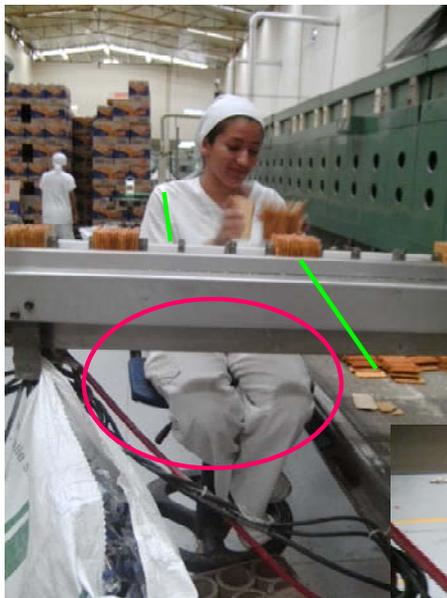
**La altura nos es adecuada para alimentar el brazo ya que los brazos de la alimentadora a granel deben quedar alineado con el brazo de la maquina de galletas**
