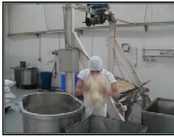
El paso a paso de la grúa al levantar el coche y dejar caer la masa al interior del ducto
